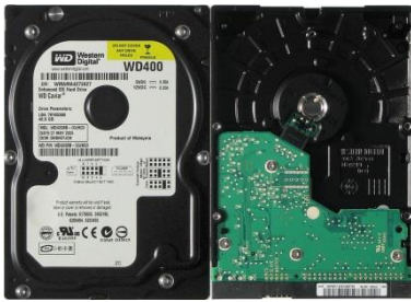
Rysunek 1. Dysk twardy 3,5" widziany z góry (po lewej) i od dołu (po prawej) (źródło: Wikipedia)
